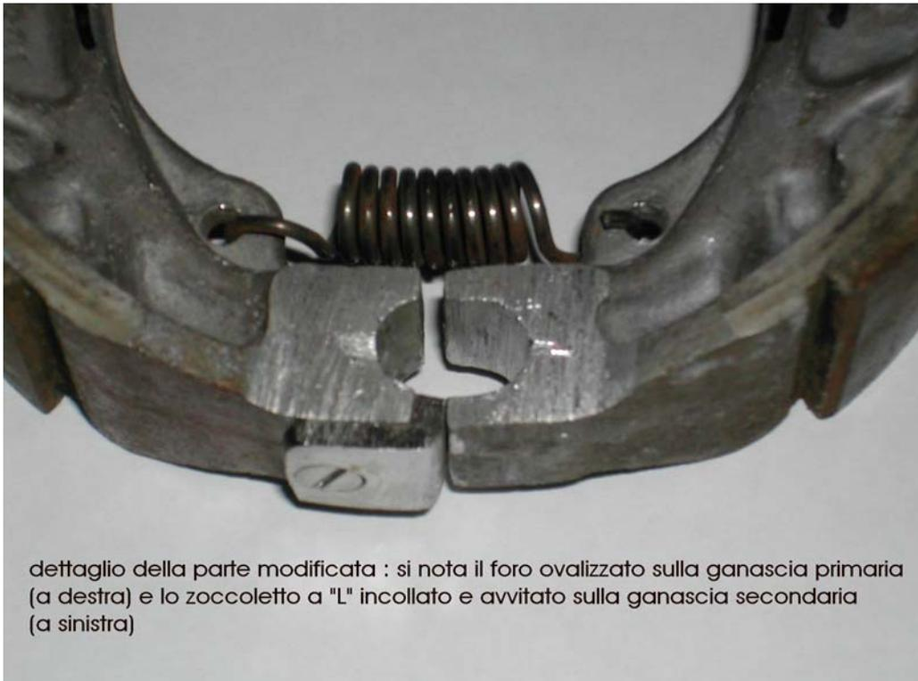
Dopo l'incollaggio, forare, filettare ed avvitare con una vite inox a testa piana di 3mm di diametro nella posizione indicata in figura
